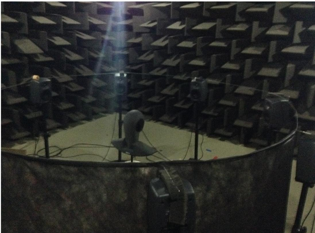
**Figura 1:** Imagem da montagem do sistema de reprodução sonora espacial numa câmara semi-aneecóica.
